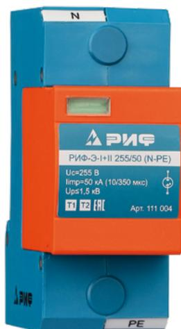
Мощное однополюсное УЗИП класса I коммутирующего типа. УЗИП выполнено в виде сменного модуля с газонаполненным разрядником и базы для подключения к сети и креплению к DIN-рейке 35 мм.
